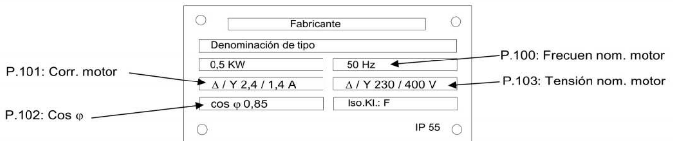
Figura 37: Ejemplo placa indicadora del motor (figura similar)
